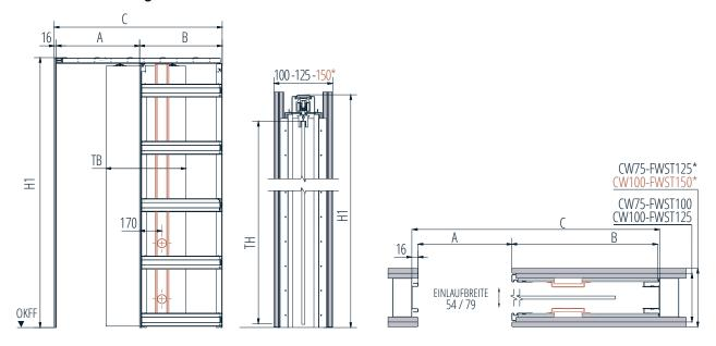
FWST = Fertigwandstärke | CW = Profilstärke | \* Doppelbeplankung | \* bei Kabelkanal vormontiert für FWST 150
