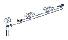
**ZUZIEHAUTOMATIK** Die Zuziehautomatik sorgt dafür, dass die geöffnete Schiebetür nach circa 11 Sekunden automatisch ins Schloss fällt, und das unsichtbar. Das gelingt allein mit dem Energieaufwand der Türöffnung und bedarf keines Stromanschlusses.
